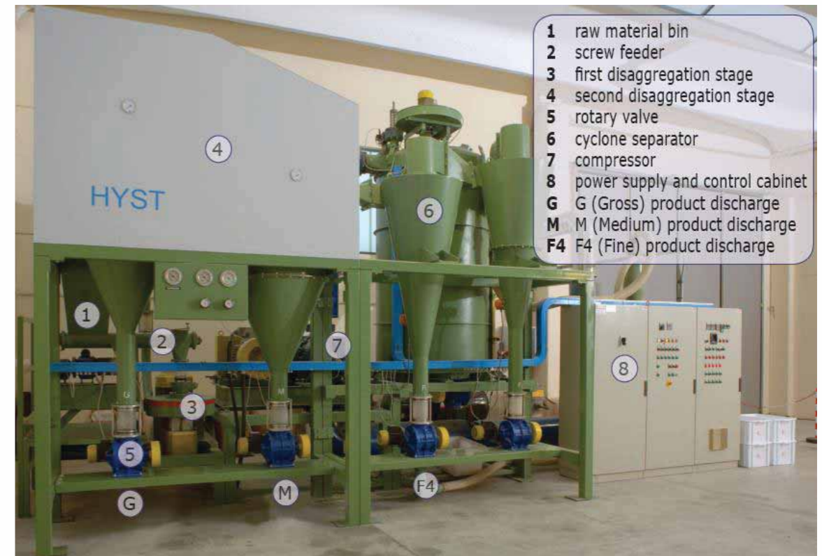
Impianto pilota HYST della capacità di 1-5 t/h
